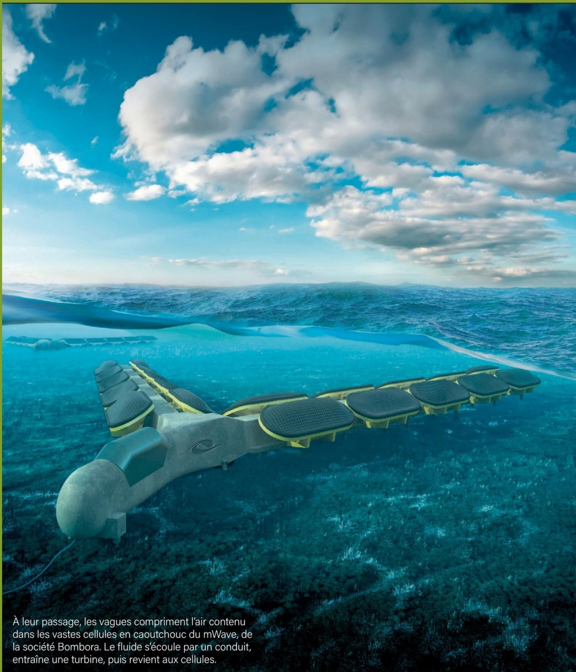
À leur passage, les vagues compriment l'air contenu dans les vastes cellules en caoutchouc du mWave, de la société Bombora. Le fluide s'écoule par un conduit, entraîne une turbine, puis revient aux cellules.
