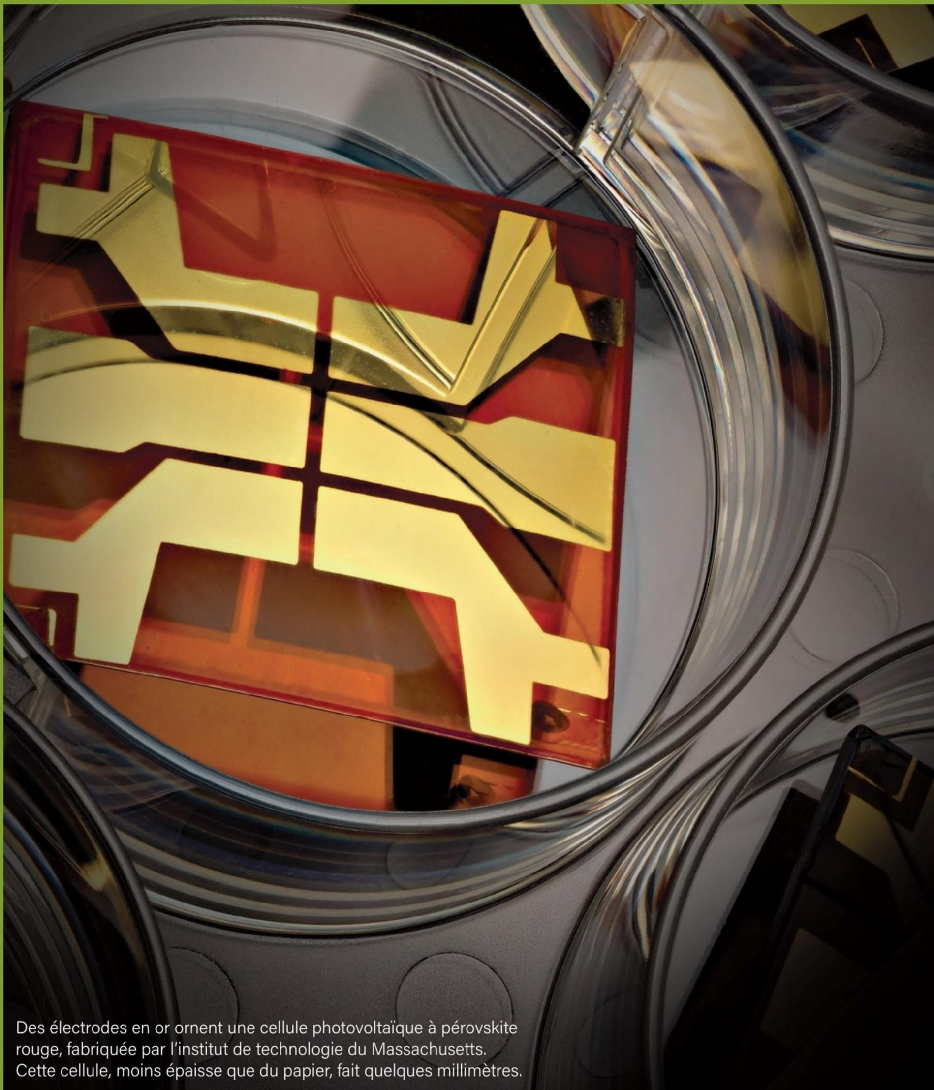
Des électrodes en or ornent une cellule photovoltaïque à pérovskite rouge, fabriquée par l'institut de technologie du Massachusetts. Cette cellule, moins épaisse que du papier, fait quelques millimètres.
