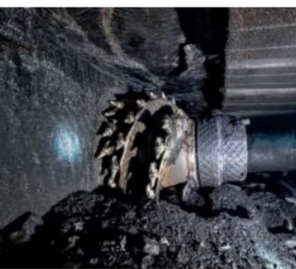
Sous terre, la haveuse racle la veine de charbon avec son tambour rotatif en acier, muni de dents en carbure de tungstène.
